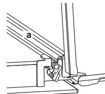
3. Sluit de deur tot deze bijna volledig dicht is en verwijder de deur door deze naar u toe te trekken.
