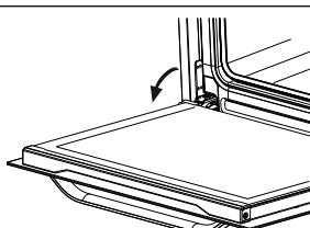
2. Open de bevestigingsbeugel (a)(met behulp van een schroevendraaier) naar de
